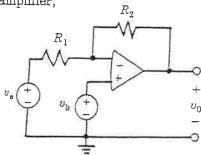
$$v_{\rm o} = -\frac{R_2}{R_1}v_{\rm a} + \left(1 + \frac{R_2}{R_1}\right)v_{\rm b}$$
